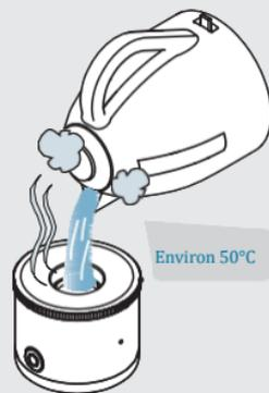
**Si le produit ne fonctionne toujours pas correctement, versez de l'eau à environ 50°C (122°F) dans le générateur d'hydrogène puis utilisez le produit après 10-30 minutes.**
